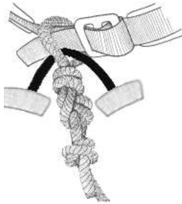
Figur 24. Dobbelt syet ottetalsknode. Anvendes til at binde sig ind med.
