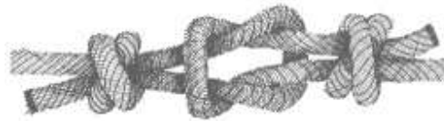
Figur 27. Råbåndsknob med 2 stopknoder. Anvendes til at binde to reb med samme diameter sammen.
