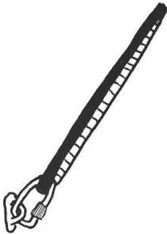
Figur 3. Bundsikring i Abekatten. Slynge fæstet med skruekarabin til hænger.
