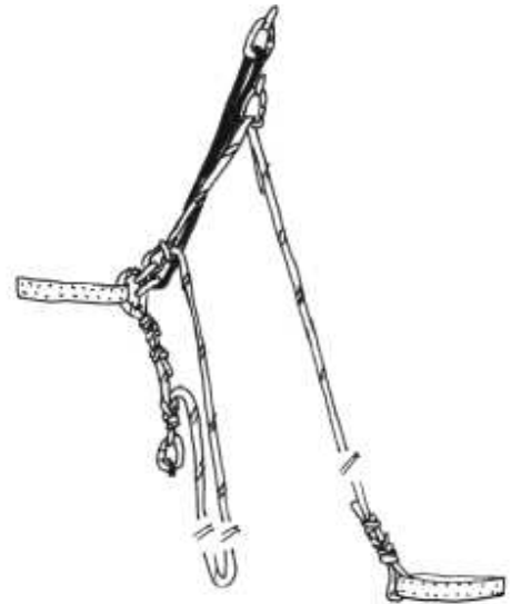
Figur 15. Sikring fra standplads
