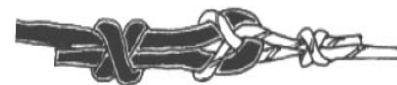
Figur 28. Flagknob. Anvendes til at binde to reb sammen, der har forskellig diameter.
