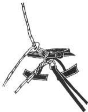
Figur 4. Indbindingspunkt med bremse og bundsikring. Rebet kommer ovenfra går gennem bremsen og skruekarabinen ned til bremsehånden.
