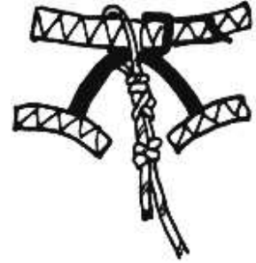
Figur 2. Indbindings-punkt. Ottetalsknode og stopknode.
